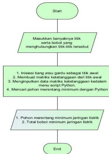
**Gambar 3.** Flowchart Optimasi Jaringan Distribusi Listrik PLN
